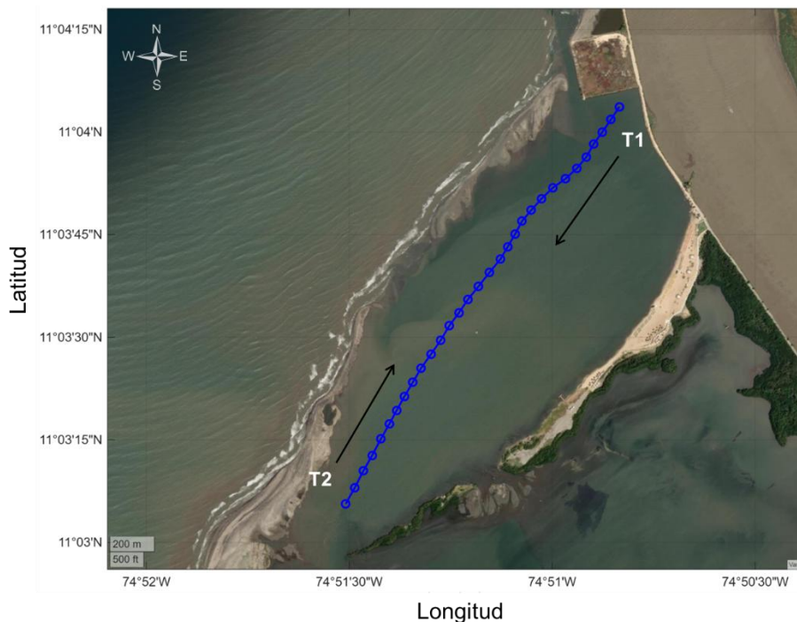
Figura 8-11. Ubicación y recorridos de los transeptos T1 y T2 en Puerto Mocho, Barranquilla. Los puntos azules indican la trayectoria de las mediciones con ADCP en movimiento, y las flechas muestran la dirección general de cada recorrido.
